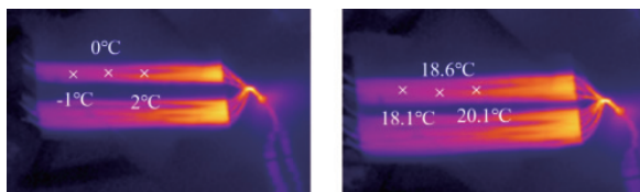
图 15 含微流道平板验证试验红外温升图
