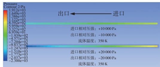
图 11 展向方向石英纤维流道压力云图
