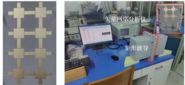
(a) ESS 测试样品 (b) 插入损耗及屏蔽效能测试场景
