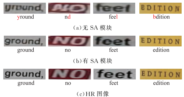
图 9 语义感知模块有效性定性对比实验结果
