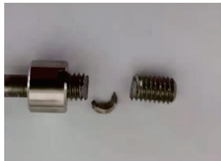
图 1 断裂螺钉外观形貌
