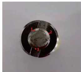
图 2 断裂螺钉外观形貌
