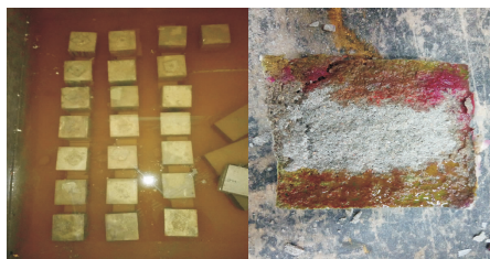
图 5 耐氯盐腐蚀性实验
