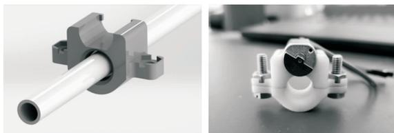
图8 振动加载装置
