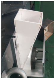
图 4 陶瓷尖劈样件及其在加工平台上的定位
