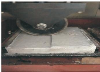
图 3 轮式冲击试验机
