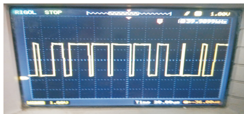
图9 部分 SVPWM 波在示波器中显示
