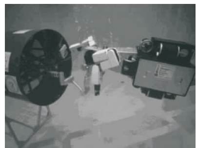
图 3 Ranger 机械臂水浮系统
