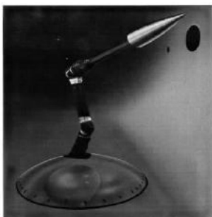
图 1 前体大迎角风洞实验模型
