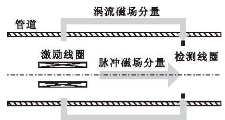
图1 脉冲激励下远场涡流检测示意图
