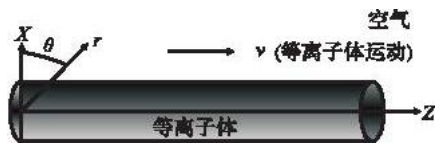
图1 等离子体通道天线的原始模型
