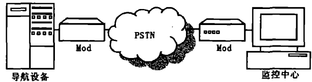
图1 远程监控系统结构框图
