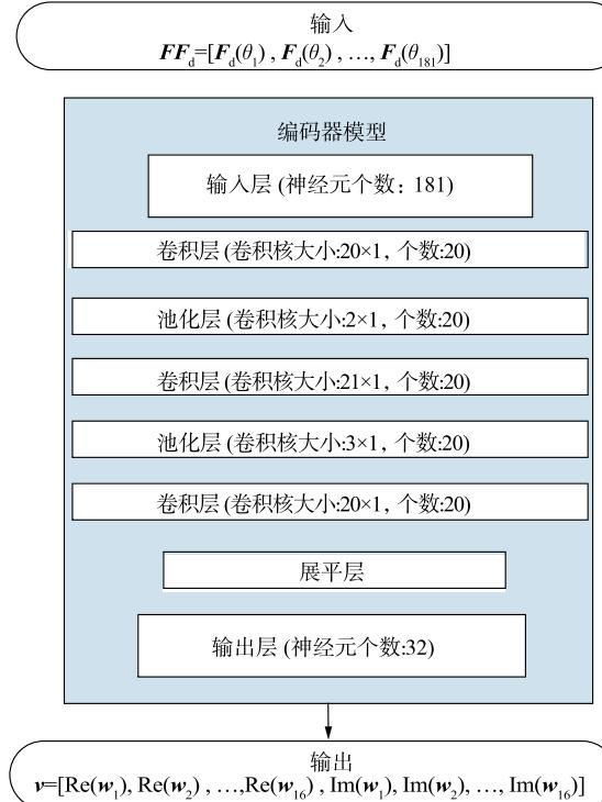
图 6 编码器结构
