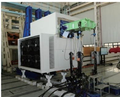
图 3 复合材料平尾盒段载荷校准试验
