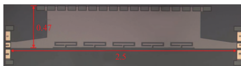
(c) 基于此传输线的带通滤波器结构
