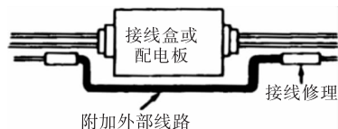
图 5 重构修复接线盒损伤示例
