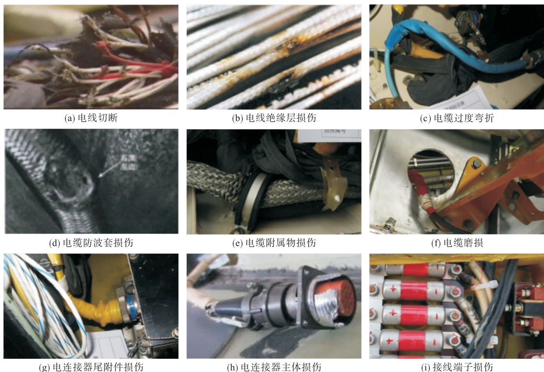
图 1 电气线路系统部分损伤模式示例
