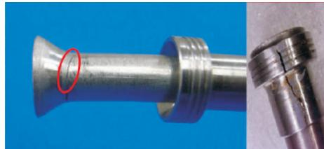
图1 液压导管裂纹渗漏故障图
