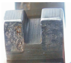
图 11 齿面啮合痕迹 Fig. 11 Meshing trace on tooth surface
