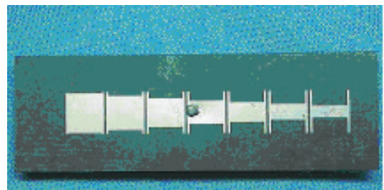
图 2 定向贴片天线实物图
