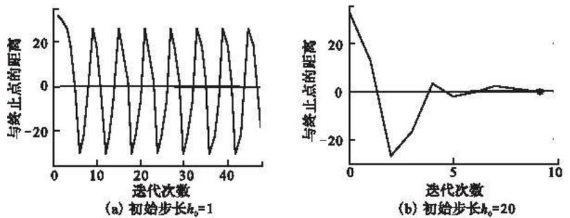
图 2 利用进退法在不同参数设定条件下的搜索结果
