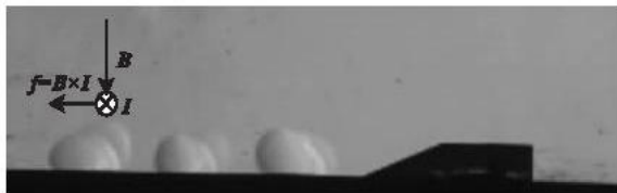
图10 无来流条件下逆气流放电纹影图像
