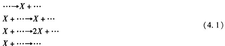
这些反应的反应速度分别是  $r_0, U_x, D_x, B_x$ , 其中  $U, D, B$  与表达式(4.1)左边的…项的化学反应物质包括链锁载体的相关密度成正比。符号  $U, D$  和  $B$  与链锁载体密度  $x$  的积表示连锁反应的相对速度<sup>[8]</sup>。
